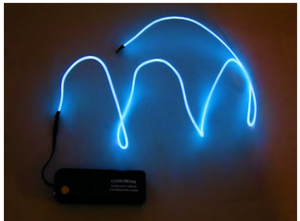
EL Wire lyser også kontinuerligt, men er som en ledning, og lyser derfor fra alle sider, og ikke kun på en overflade som det bredere EL tape.
