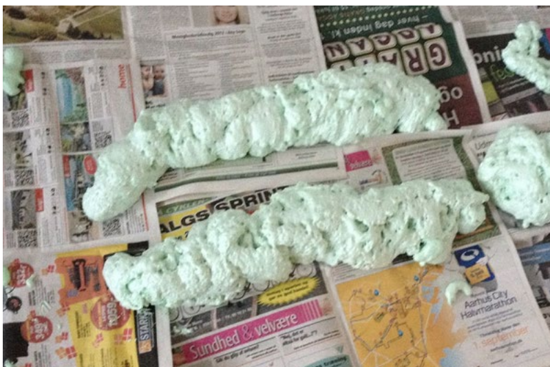
PU skum bliver ca. 20 gange så stort, efter man har sprøjtet det ud.
