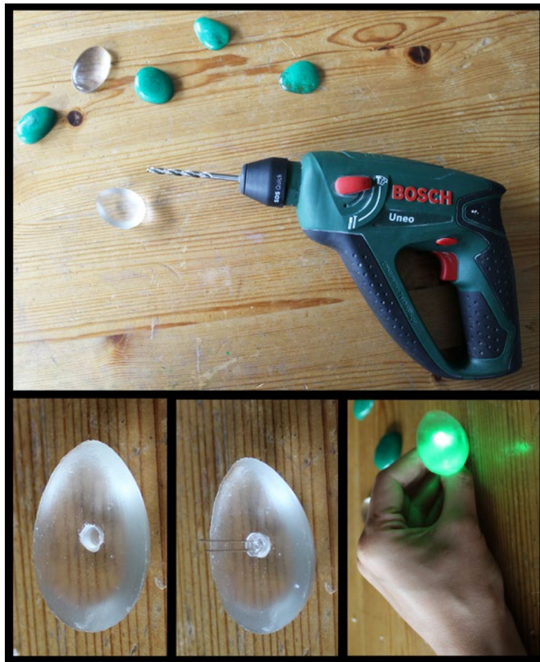
Man kan bore hul i resinen efter den er hærdet, så man kan sætte LED'er i.
