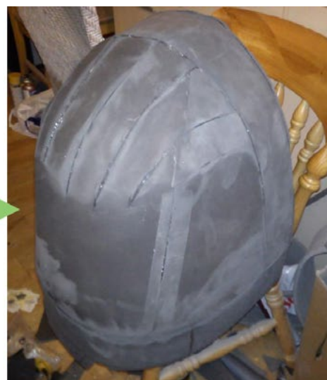
Runde former opnås ved at skære slidser i skummet og lime dem sammen. Foto: Roses and Boltshells
