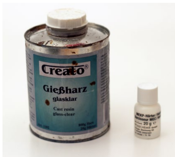
Resin kommer i mange former og farver. Ofte fås det i en dåse med en lille flaske hærder ved siden af.
